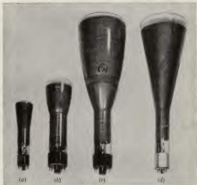
FIG. 2-10.—Typical electrostatic cathode-ray tubes: (a) 2AP1; (b) 3BP1; (c) 5CP1; (d) 5BP1.
