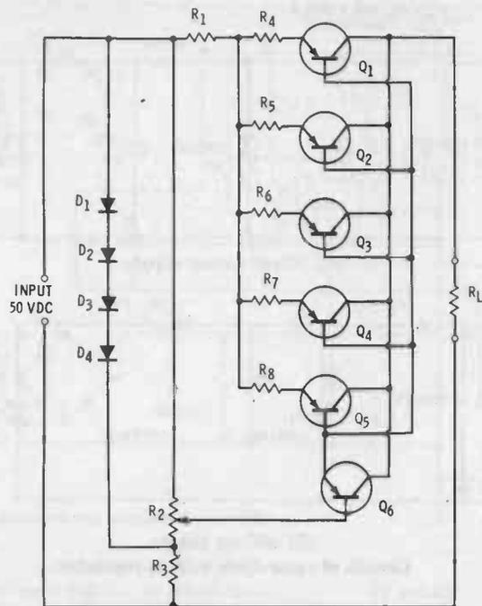
Q<sub>1</sub> thru Q<sub>5</sub> - Minneapolis-Honeywell 2N575
