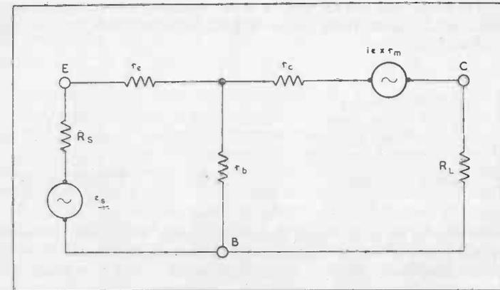
FIG 44. EARTHED BASE EQUIVALENT A.C. NETWORK.
