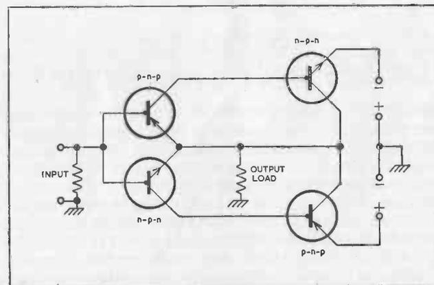
FIG. 41. A PUSH-PULL AMPLIFIER USING COMPLEMENTARY SYMMETRY.
