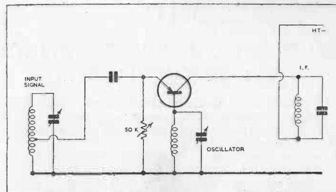
FIG. 28. FREQUENCY CHANGER USING POINT-CONTACT TRANSISTORS.
