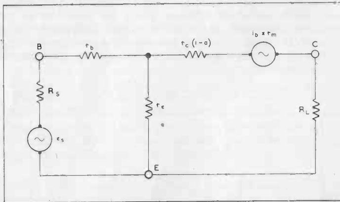
FIG. 46. EARTHED-EMITTER EQUIVALENT A.C. NETWORK.
