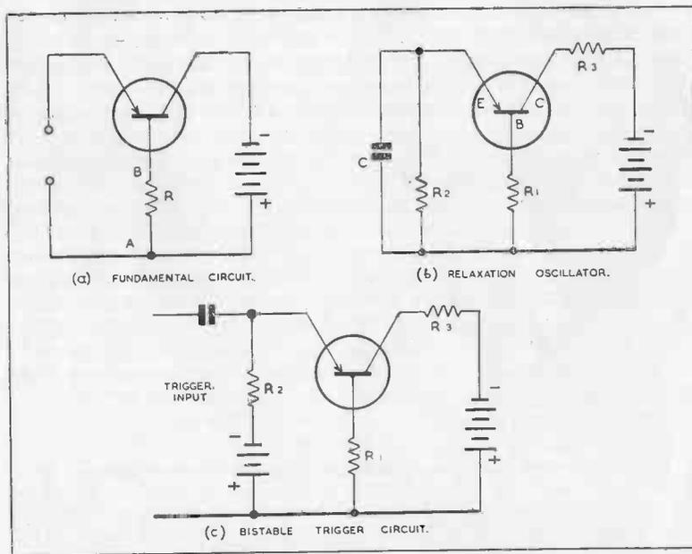
FIG. 21. NEGATIVE RESISTANCE CIRCUITS USING POINT-CONTACT TRANSISTORS.
