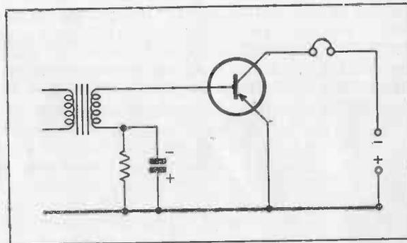
FIG. 36. BIAS ARRANGEMENT TO GIVE  $I_c$  GREATER THAN  $I_e$ .
