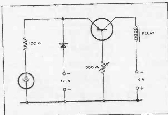
FIG. 31. TRIGGER CIRCUIT.
