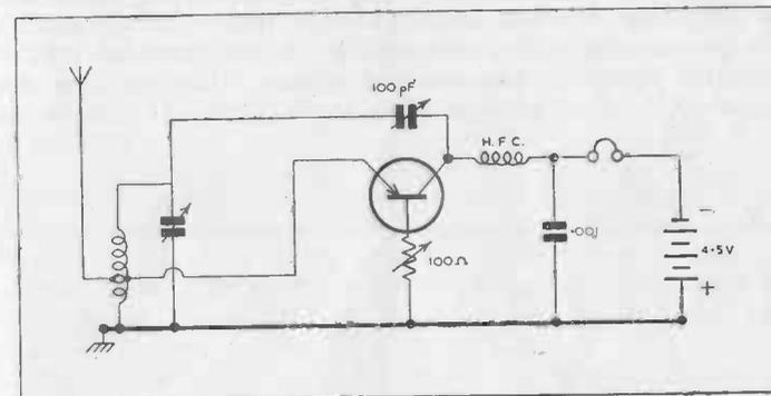
FIG. 22. SIMPLE TRANSISTOR RECEIVER.
