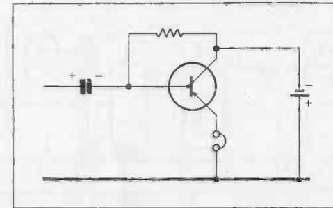
FIG. 37. EARTHED-COLLECTOR AMPLIFIER.
