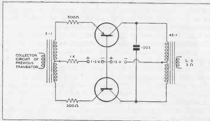
FIG. 24. PUSH-PULL OUTPUT STAGE.
