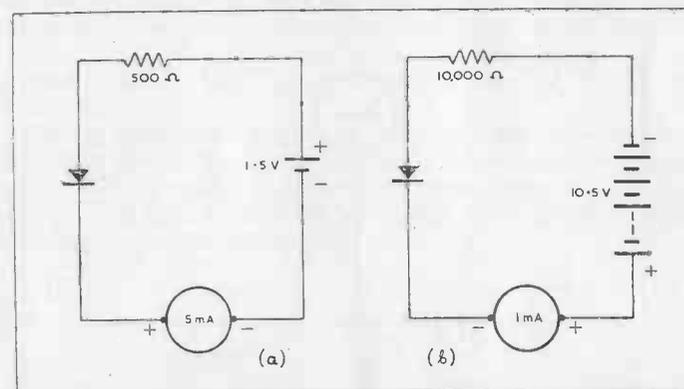
Fig. 42(a). CIRCUIT TO CHECK FORWARD RESISTANCE OF A GERMANIUM DIODE.
