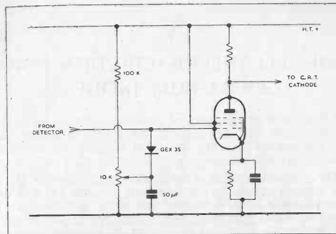
FIG. 13. TV SPOT LIMITER IN GRID CIRCUIT OF VIDEO VALVE.
