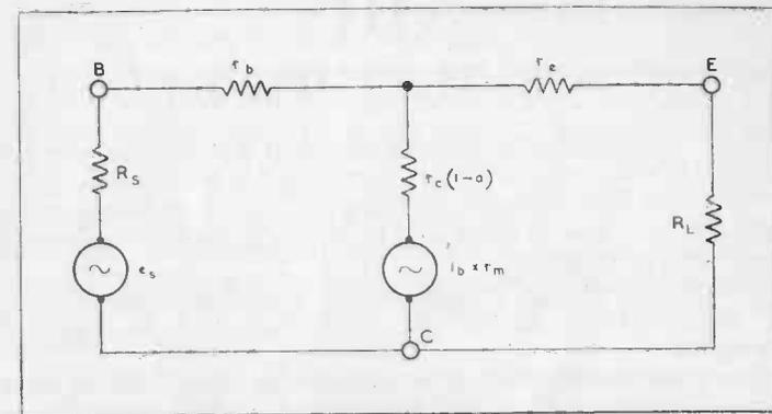
FIG. 47. EARTHED-COLLECTOR EQUIVALENT A.C. NETWORK.
