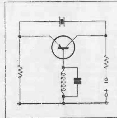
FIG. 30. CRYSTAL CONTROLLED TRANSISTOR OSCILLATOR.
